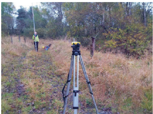
Réalisation des relevés topographiques au Greil-Rascoupet © I-Delpy SMPNRVA
