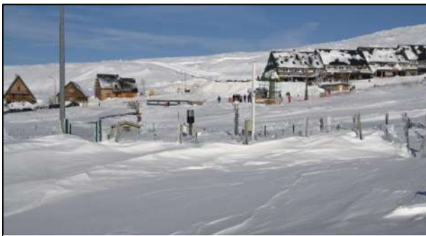
Figure 2 – Station automatique de Chastreix-Sancy localisée à 1385 m d'altitude. L'omniprésence des vents illustrée par la présence des congères sur la photo complique la mesure des précipitations et des épaisseurs de neige au sol – Février 2015 – Cliché F. Serre
